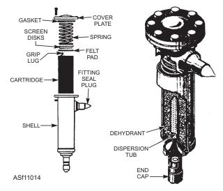
Figure 11-14.—Drier-strainer (dehydrator).
