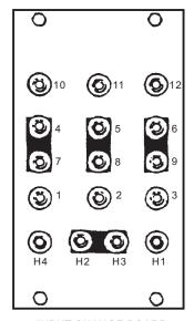
INPUT CHANGE BOARD STRAPPED FOR 440V OPERATION ASf07057
