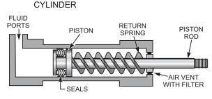
C. SINGLE-ACTING, SPRING-LOADED PISTON TYPE ACTUATING CYLINDER
