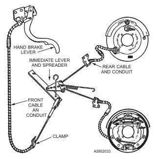
Figure 2-33.—Mechanical brake system—cables.
